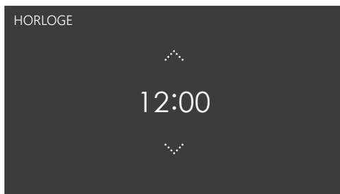
1. Tapez sur les flèches situées au-dessus et au-dessous de l'heure ou balayez l'heure pour l'adapter.
