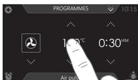
1. Tapez au milieu du symbole de la fonction, de la température, de la puissance ou du temps de cuisson (activé). Le clavier apparaît.
